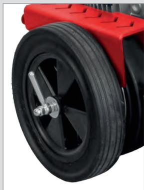
Ruote per il trasferimento della macchina
