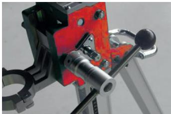
5.1.7 Insieme al supporto più piccolo viene fornita una staffa di fissaggio da 60 mm come nel COLONNA 200, mentre il COLONNA 250 è dotato sia di staffa di fissaggio che di distanziale di montaggio. Entrambi i metodi di montaggio dipendono dal tipo di motore. Es. Se il COLONNA 200 è dotato di un motore portatile, è necessario utilizzare una staffa di fissaggio da 60 mm per montarlo sul supporto.
