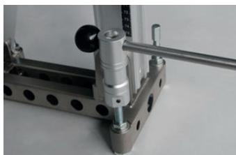
il perfetto fissaggio del basamento. Attenzione! Quando si esegue una perforazione aerea, non è possibile eseguire un fissaggio a vuoto sul soffitto, poiché ciò potrebbe causare gravi lesioni.
