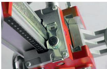
5.1.9 Quando si monta un motore a 4 bulloni sul supporto COLONNA 250, utilizzare i 4 bulloni per installare prima il distanziatore sul motore. Sulla piastra di montaggio è presente una chiave da 10x10x100 mm in grado di trasmettere la coppia del motore. Quindi inserire la piastra di montaggio con coda di rondine nella base. Serrare il bullone di bloccaggio della base fino a fissare correttamente la piastra.
