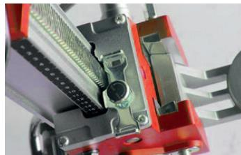
de montage sur le moteur. La plaque de montage comporte une clavette de 10x10x100 mm qui peut transmettre le couple du moteur. Placer ensuite la plaque de montage avec queue d'aronde dans le berceau. Serrer le boulon de verrouillage du berceau jusqu'à ce que la plaque soit fixée dans ce dernier.
