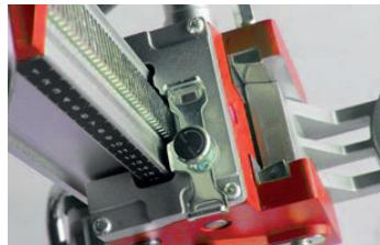
équipé d'un support de serrage et d'une entretoise de montage. Les deux méthodes de montage dépendent du type de moteur de forage. Par exemple, le DMP-162 est un moteur de forage portatif, il faut donc utiliser le support de serrage  $\Phi$  60 mm pour le monter sur le support
